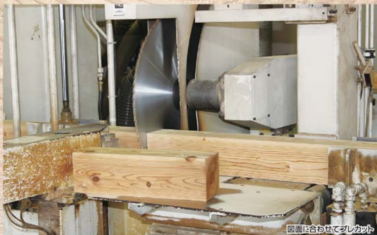
図面に合わせてブランクカット
